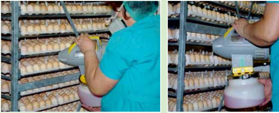
Газация яиц после переборки аэрозольным генератором «Небуло»
